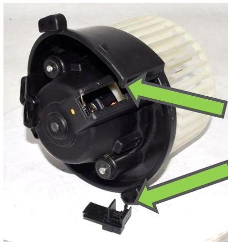
3) Smontaggio punti esterni di fissaggio
