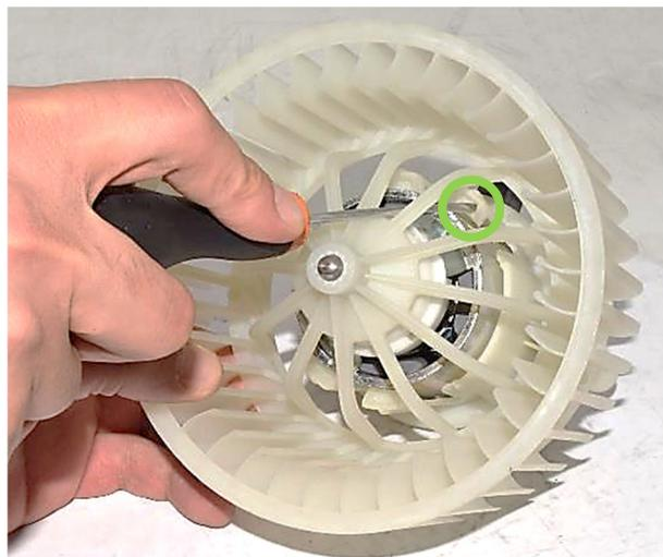
7) Rimozione alloggiamento motore ventola abitacolo
