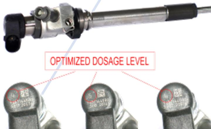
Цифры в красном кружке обозначают степень оптимальной дозировки топлива. Различные значения могут вызвать дисбаланс и нарушения в работе двигателя и в управлении выхлопными газами.
